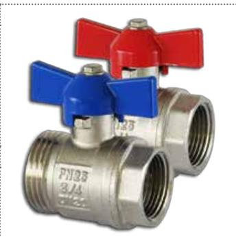
2 x Kugelhahn 3/4" IG x 1" AG, flachdichtend, Anschluss horizontal, u.a. zum Absperrern von Vorlauf und Rücklauf der Verteiler HKV-VA, Baulänge = 50 mm
