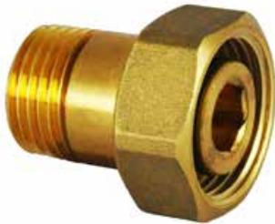
Anschlussverschraubung  $\frac{3}{4}$ " zum Anschluss von Unterverteilern bzw. Steckanschlüssen an Verteiler, Ventile, bestehend aus Überwurfmutter G  $\frac{3}{4}$ " Eurokonus weichdichtend und Tülle R  $\frac{1}{2}$
