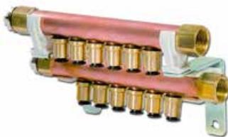
Verteilerbaugruppe 6-fach mit Vorlauf- und Rücklaufbalken, je 6  $\times$  Steckanschluss  $\varnothing$  8 mm - 2  $\times$  1/2" IG (inkl. 2  $\times$  Entlüfter, 12  $\times$  Stützhülse), für Flächen bis 24 m<sup>2</sup>\*.
