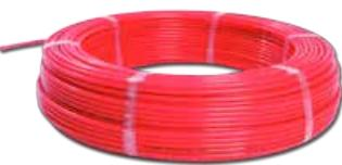
5-Schicht-Verbundrohr ø 10 × 1,3 mm (Bund 300 m), sauerstoffdicht nach DIN 4726, max. Temperatur 95 °C, Nenndruck 6 bar, Prüfdruck 10 bar, Verbrauch ca. 8,5 m / m<sup>2</sup> Boden, max. Heizkreislänge 70 m = ca. 8 m<sup>2</sup>\*
