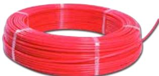
5-Schicht-Verbundrohr ø 10 × 1,3 mm (Bund 150 m), sauerstoffdicht nach DIN 4726, max. Temperatur 95 °C, Nenndruck 6 bar, Prüfdruck 10 bar, Verbrauch ca. 8,5 m / m<sup>2</sup> Boden, max. Heizkreislänge 70 m = ca. 8 m<sup>2</sup>\*
