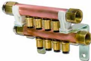
Verteilerbaugruppe 4-fach mit Vorlauf- und Rücklaufbalken, je 4  $\times$  Steckanschluss  $\varnothing$  8 mm - 2  $\times$  1/2" IG (inkl. 2  $\times$  Entlüfter, 8  $\times$  Stützhülse), für Flächen bis 16 m<sup>2</sup>\*.
