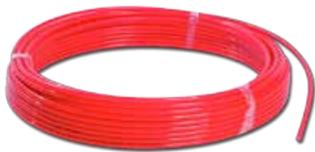
5-Schicht-Verbundrohr ø 10 × 1,3 mm (Bund 75 m), sauerstoffdicht nach DIN 4726, max. Temperatur 95 °C, Nenndruck 6 bar, Prüfdruck 10 bar, Verbrauch ca. 8,5 m / m<sup>2</sup> Boden, max. Heizkreislänge 70 m = ca. 8 m<sup>2</sup>\*
