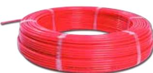
5-Schicht-Verbundrohr ø 8 x 1,1 mm (Bund 600 m), sauerstoffdicht nach DIN 4726, max. Temperatur 95 °C, Nenndruck 6 bar, Prüfdruck 10 bar, Verbrauch ca. 8,5 m / m<sup>2</sup> Boden, max. Heizkreislänge 35 m = ca. 4 m<sup>2</sup>\*
