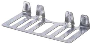
Stahlblech verzinkt, l = 85 mm, zur Fixierung der Wabenplatten an den Randdämmstreifen, Verbrauch ca. 3 Stück / m
