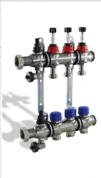
Alle Verteiler werden inkl. Absperrset ASH geliefert. Weitere Ausführungen auf Anfrage! Edelstahlverteiler 1", Ventileinsätze M30 x 1,5 u. Durchflussregler vormontiert, Bauteillängen (inkl. ASH) siehe Tabelle.
