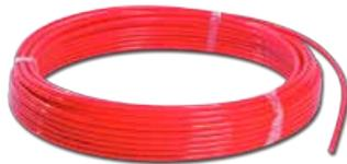
5-Schicht-Verbundrohr ø 8 x 1,1 mm (Bund 40 m), sauerstoffdicht nach DIN 4726, max. Temperatur 95 °C, Nenndruck 6 bar, Prüfdruck 10 bar, Verbrauch ca. 8,5 m / m<sup>2</sup> Boden, max. Heizkreislänge 35 m = ca. 4 m<sup>2</sup>\*
