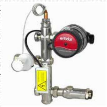
Mit elektronisch geregelter Pumpe Lowara eco Floor-T1 15-6, Vorlauftemperatur einstellbar, inkl. Sicherheitstemperaturbegrenzer, Gesamtbau­teillänge 290 mm.
