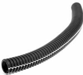
Bauschutz-Wellrohr, l = 300 mm, zum mechanischen Schutz der Heizrohre an den Austrittsstellen des Bodensystems und im Bereich von Durchführungen (z.B. Profifuge)
