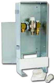
Zur Einzelraumregelung mittels Thermostatventil ohne Begrenzung der Rücklauf­temperatur für Einsatz in vorgemischtem Fußbodenheizkreis, UP-Box mit **tapezier- oder befliestbarer Abdeckung**, geschlossen, inkl. Thermostatventil mit Fernversteller, für Flächen bis 16 m<sup>2</sup>\* (UV4-8) / bis 20 m<sup>2</sup>\* (UV4-10)
