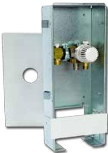
Zur Einzelraumregelung mittels Thermostatventil ohne Begrenzung der Rücklauf­temperatur für Einsatz in vorgemischtem Fußbodenheizkreis, UP-Box mit **Abdeckung weiß**, Öffnung für Thermostatventil nach vorn, für Flächen bis 16 m<sup>2</sup>\* (UV4-8) / bis 20 m<sup>2</sup>\* (UV4-10)
