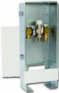
Zur Einzelraumregelung mittels Thermostatventil ohne Begrenzung der Rücklauf­temperatur für Einsatz in vorgemischtem Fußbodenheizkreis, UP-Box mit **Abdeckung weiß**, geschlossen, inkl. Thermostatventilunterteil (vorbereitet für Stellantrieb Anschlussgewinde M30 × 1,5; nicht im Lieferumfang enthalten), für Flächen bis 16 m<sup>2</sup>\* (UV4-8) / bis 20 m<sup>2</sup>\* (UV4-10)
