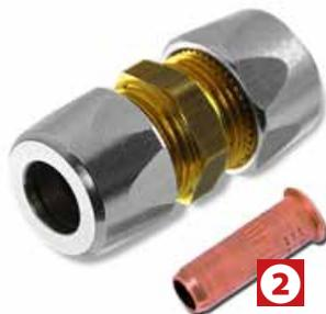
Rohrstutzen Quetschverschraubung  $\varnothing$  8 mm auf Quetschverschraubung  $\varnothing$  8 mm, flachdichtend mit EPDM (Gummi), inkl. 2  $\times$  Stützhülse.
