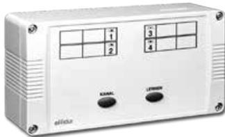
Aufputz / Wandmontage, Schließer 5 (1) A, 230 V, 50 Hz, Umgebung -10...50 °C, max. 4 Stellantriebe je Kanal, Schutzart IP 20, Lichtgrau. Montage optional mit Magnetbefestigungs-Set (siehe Zubehör).
