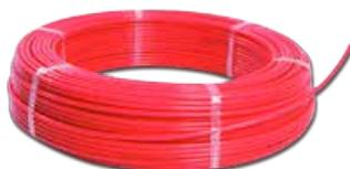
5-Schicht-Verbundrohr ø 8 x 1,1 mm (Bund 200 m), sauerstoffdicht nach DIN 4726, max. Temperatur 95 °C, Nenndruck 6 bar, Prüfdruck 10 bar, Verbrauch ca. 8,5 m / m<sup>2</sup> Boden, max. Heizkreislänge 35 m = ca. 4 m<sup>2</sup>\*
