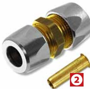
Rohrstutzen Quetschverschraubung ø 10 mm auf Quetschverschraubung ø 10 mm, flachdichtend mit EPDM (Gummi), inkl. 2 x Stützhülse.
