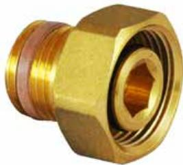
Anschlussverschraubung  $\frac{3}{4}$ " zum Anschluss von Unterverteilern bzw. Steckanschlüssen an Verteiler, Ventile, mit selbstdichtender Tülle R  $\frac{1}{2}$  durch PTFE-Gewindedichtring. Bestehend aus Überwurfmutter G  $\frac{3}{4}$ " Eurokonus weichdichtend und Tülle R  $\frac{1}{2}$  - L = 28 mm; SW 30
